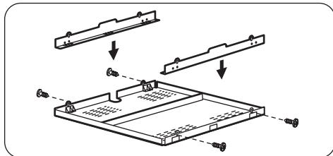
Si vous utilisez une enceinte de protection (accessoire en option<sup>1)</sup>), l'espace de circulation d'air de 2 mm et le fond de protection installé directement sous l'appareil ne sont plus nécessaires.
