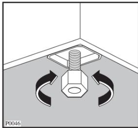
**Ne démontez pas les pieds, ne limitez pas la circulation de l'air au sol** par de tapis à longs poils, des moulures, etc. Il pourrait se produire une accumulation de chaleur qui nuirait au bon fonctionnement du moteur ou risquerait de l'endommager.
