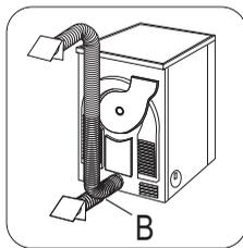
reflue dans le sèche-linge, percez un petit trou (de 3 mm) au point le plus bas du tuyau et déposez un petit récipient au-dessous. (Voir la figure, point B).
