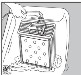
Nettoyez aussi l'extérieur du condenseur d'air et le cas échéant, enlevez également les peluches. Nettoyez le joint autour du condenseur à l'avant et à l'arrière ainsi que le joint à la partie intérieure du portillon à l'aide d'un chiffon humide.
