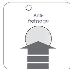
Si vous avez sélectionné cette fonction supplémentaire, la phase anti-froissage est prolongée de 90 minutes à la fin du cycle de séchage. Au cours de la phase antifroissage, le linge peut être retiré à tout instant.
