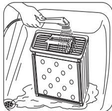
4. Nettoyez-le avec une brosse et rincez-le sous l'eau courante. Nettoyez également l'extérieur en éliminant toutes les peluches. Nettoyez le joint en caoutchouc autour du condenseur et l'intérieur du volet à l'aide d'un chiffon humide.
