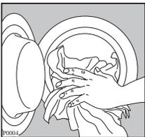
Ouvrez le hublot en tirant avec précaution vers l'extérieur la poignée. Placez les articles un à un dans le tambour, en les dépliant le plus possible. Fermez le hublot.
