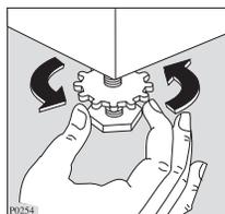
Placez l'appareil à l'endroit choisi et procédez soigneusement à la mise à niveau, en agissant sur les vérins prévus à cet effet.
