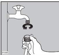
Si nécessaire rectifiez la position du raccord de vidange en dévissant la bague de serrage placée à l'arrière de l'appareil.
