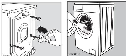
Ouvrez le hublot et enlevez le bloc en polystyrène accroché avec du ruban adhésif au joint du hublot.
