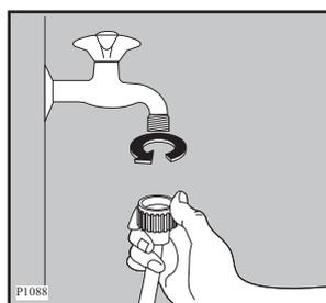
Si nécessaire rectifiez la position du raccord de vidange en dévissant la bague de serrage placé à l'arrière de l'appareil.
