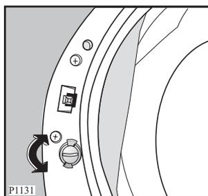
Pour désactiver ce dispositif et permettre la fermeture du hublot, tournez le bouton dans le sens inverse des aiguilles d'une montre jusqu'à ce que la rainure soit à la verticale.
