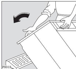
Appuyez l'appareil sur la partie arrière et mettez entre le sol et le lave linge une des cales en polystyrène.
