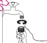
Vissez le raccord du tuyau d'alimentation sur le nez fileté au robinet d'arrivée d'eau (20 x 27). Utilisez toujours le tuyau livré avec l'appareil.
