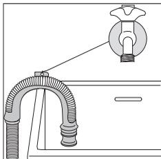
**Sur le bord d'un lavabo** à l'aide d'un guide en plastique livré avec le lave-linge.
