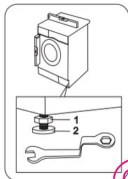
Placez l'appareil sur un sol plat et dur. Vérifiez que la circulation d'air autour de l'appareil n'est pas entravée par des moquettes, tapis, etc. Veillez à ce que l'appareil ne touche pas le mur ou les autres meubles de la cuisine. Procédez à la mise à niveau de l'appareil en relevant ou en abaissant les pieds. La vis autobloquante des pieds peut
