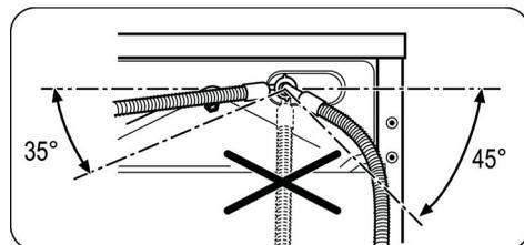
L'autre extrémité du tuyau d'arrivée d'eau raccordée à l'appareil peut être tournée (reportez-vous à l'illustration). Ne raccordez jamais le tuyau d'arrivée d'eau verticalement. Orientez le tuyau en angle vers la direction (droite ou gauche) la plus proche du robinet de l'eau. Ajustez correctement le tuyau en dévissant la bague de serrage. Après avoir positionné le tuyau d'alimentation, veillez à revisser correctement la bague de serrage pour éviter toute fuite.
