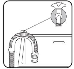
À cet effet, vous pouvez fixer le tuyau au robinet à l'aide d'une ficelle ou le fixer au mur.
