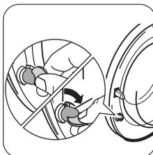
Pour **activer** ce dispositif, tournez le bouton (sans appuyer) situé à l'intérieur du hublot dans le sens des aiguilles d'une montre jusqu'à ce que la rainure soit horizontale. Si nécessaire, utilisez une pièce de monnaie.
