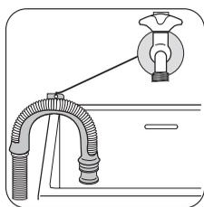
**Sur le bord d'un lavabo à l'aide d'un guide en plastique livré avec l'appareil.**
