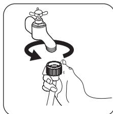
Raccordez le tuyau à un robinet fileté (3/4 pouce). Utilisez toujours le tuyau livré avec l'appareil.
