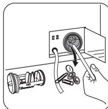
Enlevez les corps étrangers et les peluches du filtre et de la turbine de la pompe.
