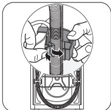
Retirez le câble d'alimentation électrique et le tuyau des supports placés à l'arrière de l'appareil.
