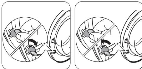
Pour **activer** ce dispositif, faites tourner (sans appuyer dessus) le bouton situé à l'intérieur du hublot vers la droite jusqu'à ce que la rainure soit horizontale. Si nécessaire, utilisez une pièce de monnaie.
