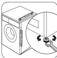
Le cas échéant, vérifiez le niveau avec un niveau à bulle.
