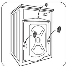
Bouchez l'ouverture centrale supérieure et les deux ouvertures en bas à l'aide des caches en plastique correspondants, placés à l'intérieur de l'enveloppe contenant la notice d'utilisation.
