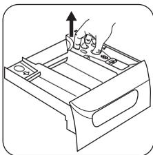
Pour faciliter le nettoyage, la partie supérieure du compartiment réservé à l'additif doit être enlevée.
