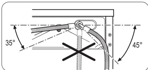
L'autre extrémité du tuyau d'arrivée d'eau raccordée à l'appareil peut être tournée, comme illustré.
