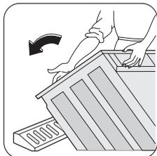
Après avoir enlevé les protections de transport, appuyez avec soin l'appareil sur la partie arrière pour retirer le bloc en polystyrène qui constitue le socle de l'emballage.
