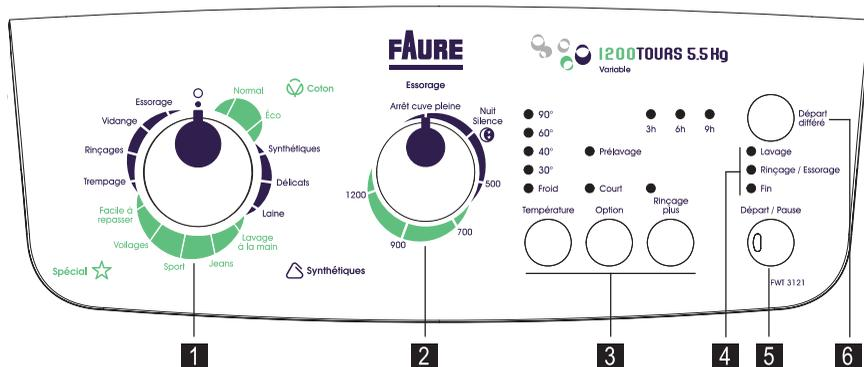
1. **Sélecteur de programmes** : Sur la position
