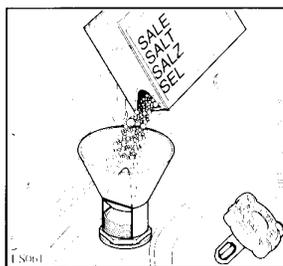
A l'aide de l'entonnoir livré avec l'appareil, versez dans le réservoir 1,5-1,8 kg environ de sel.
