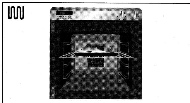
Regolare il selettore **1** alla temperatura necessaria. Per la funzione grill intenso regolare la temperatura a 300°C.
