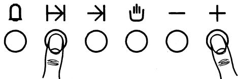
Vijf seconden na het programmeren wordt de dagtijd weer aangegeven. De geprogrammeerde duur kan worden gecontroleerd door op de betreffende toets te drukken.
