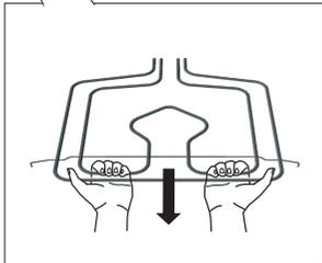
Tirez le grill vers le bas jusqu'à ce que la barre transversale qui repose sur les deux supports latéraux (à droite et à gauche) soit dégagée.
