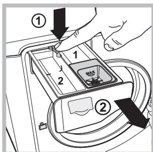
Drücken Sie auf den Arretierhebel (1) und ziehen Sie die Waschmittelschublade nach vorne heraus (2) (siehe Abbildung). Spülen Sie diese regelmäßig unter fließendem Wasser gründlich aus.
