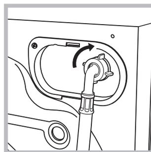
1. Raccorder le tuyau d'arrivée de l'eau à l'appareil en le vissant à la prise d'eau prévue, dans la partie arrière en haut à droite (voir figure).
