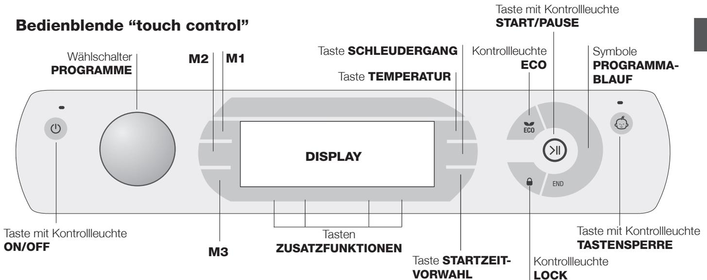
Taste mit Kontrollleuchte **ON/OFF**: Drücken Sie kurz auf die Taste, um das Gerät ein- bzw. auszuschalten. Die grüne Kontrollleuchte zeigt an, dass das Gerät eingeschaltet ist. Um den Waschvollautomaten während eines Waschganges auszuschalten, muss die Taste etwas länger gedrückt werden (ca. 3 Sekunden); ein kurzer oder ein ungewollter Druck bewirkt kein Ausschalten des Gerätes.
