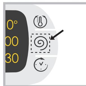
Para modificar las programaciones presionar levemente en el icono dentro del área sensible (touch control) como se indica en la figura.
