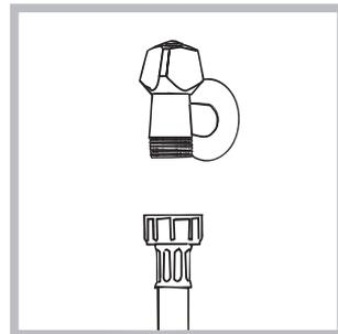
2. Conecte el tubo de alimentación enroscándolo a un grifo de agua fría con la boca roscada de 3/4 gas (ver la figura).
