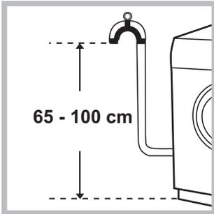
Verbind de afvoerbuis, zonder hem te buigen, aan een afvoerleiding of aan een afvoer in de muur die zich tussen de 65 en 100 cm van de grond af bevindt.
