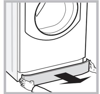
1. verwijder het afdekpaneel aan de voorzijde van de wasautomaat door er op het midden op te drukken. Duw beide zijanten naar beneden toe en verwijder het paneel (zie afbeeldingen).
