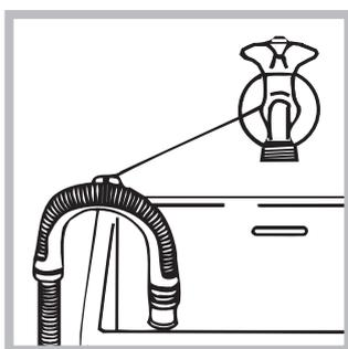
Una alternativa es apoyar el tubo de descarga en el borde de un lavamanos o de una bañera, uniéndose la guía suministrada con el aparato, al grifo (ver la figura). El extremo libre del tubo de descarga no debe permanecer sumergido en el agua.
