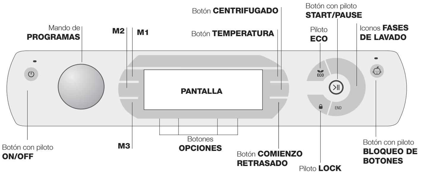
Botón con piloto **ON/OFF**: presione brevemente el botón para encender o apagar la máquina. El piloto verde indica que la máquina está encendida. Para apagar la lavadora durante el lavado, es necesario mantener presionado el botón durante más tiempo, aproximadamente 3 seg.; si se presiona en forma más breve o accidental, la máquina no se apagará. Si la máquina se apaga durante un lavado en curso, dicho lavado se anulará.
