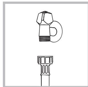
2. Schrauben Sie den Wasserschlauch an einen Kaltwasserhahn mit 3/4-GAS-Gewindeanschluss an (siehe Abbildung).
