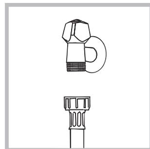
2. Sluit de toevoerbuiss aan op de koudwaterkraan met een mondstuk met schroefdraad van 3/4 gas (zie afbeelding).
