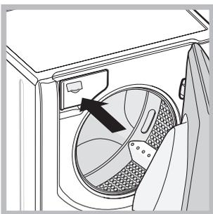
Het wasmiddelbakje bevindt zich aan de binnenkant van de automaat en verschijnt als u de deur opent. Voor de dosering van wasmiddelen zie het hoofdstuk "Wasmiddelen en wasgoed".
