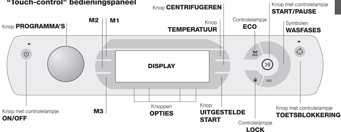
Knop met controlelampje **ON/OFF**: druk even op de knop om de wasautomaat aan of uit te zetten. Het groene controlelampje geeft aan dat de wasautomaat aanstaat. Om de wasautomaat tijdens de wascyclus uit te zetten moet u de knop iets langer, circa 3 seconden, ingedrukt houden. Als u de kort of per ongeluk indrukt zal de wasautomaat niet uitgaan. Als u de wasautomaat tijdens de wascyclus uitdoet wordt de cyclus automatisch geannuleerd.
