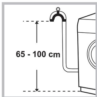
Collegare il tubo di scarico a una conduttura di scarico o a uno scarico a muro posti tra 65 e 100 cm da terra evitando assolutamente di piegarlo.
