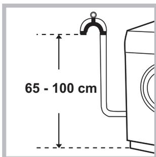
Conecte el tubo de descarga a una tubería de descarga o a una descarga de pared ubicadas a una distancia del piso comprendida entre 65 y 100 cm., evitando siempre plegarlo.
