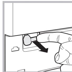
4. Entfernen Sie mithilfe der Zunge (nach vorne ziehen) die Kunststoff-Spannvorrichtung aus der Arretierung. Ziehen Sie die Spannvorrichtung jetzt nach unten, bis ein deutliches Klicken anzeigt, dass die Tür entriegelt ist.
