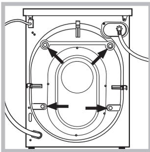
2. Verwijder de 4 beschermerschroeven voor het transport en de bijbehorende afstandsleider die zich aan de achterkant bevinden (zie afbeelding).
