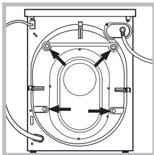
2. Schrauben Sie die 4 Transportschutzschrauben aus und nehmen Sie das entsprechende an der Rückwand befindliche Distanzstück ab (siehe Abbildung).
