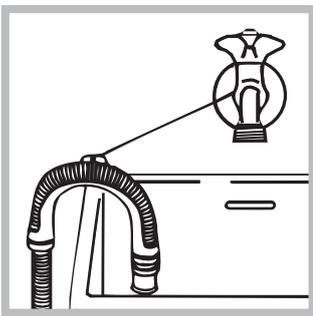
Als alternatief kunt u de afvoerbuis aan de rand van een wasbak of badkuip hangen nadat u hem met de steun aan de kraan heeft bevestigd (zie afbeelding). Het uiteinde van de afvoerslang mag niet onder water hangen.
