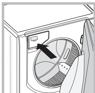
Der Waschmittelbehälter befindet sich im Innern des Gerätes, um ihn zu erreichen, muss die Gerätetür geöffnet werden. Hinsichtlich der Dosierung des Waschmittels verweisen wir auf den Absatz „Waschmittel und Wäsche“ .
