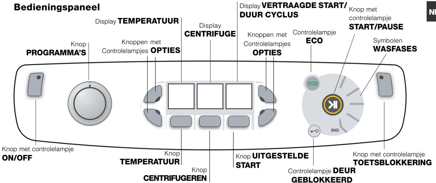
Knop met controlelampje **ON/OFF**: druk even op de knop om de wasautomaat aan of uit te zetten. Het groene controlelampje geeft aan dat de wasautomaat aanstaat. Om de wasautomaat tijdens de wascyclus uit te zetten moet u de knop iets langer, circa 3 seconden, ingedrukt houden. Als u de kort of per ongeluk indrukt zal de wasautomaat niet uitgaan. Als u de wasautomaat tijdens de wascyclus uitdoet wordt de cyclus automatisch geannuleerd.
