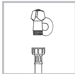
2. Συνδέστε το σωλήνα τροφοδοσίας βιδώνοντάς τον σε ένα κρουνού κρούου νερού με στόμιο σπειρώματος 3/4 gas (βλέπε εικόνα).
