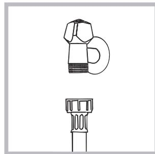
2. Sluit de toevoerbuisk aan op de koudwaterkraan met een mondstuk met schroefdraad van 3/4 gas (zie afbeelding).
