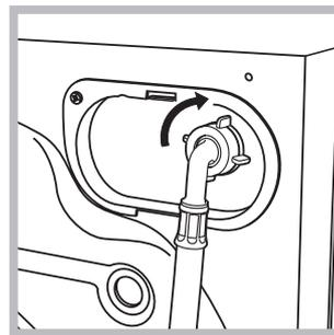
1. Συνδέστε το σωλήνα τροφοδοσίας στο πλυντήριο βιδώνοντάς τον στην αντίστοιχη είσοδο νερού, στο πίσω μέρος επάνω δεξιά (βλέπε εικόνα).
