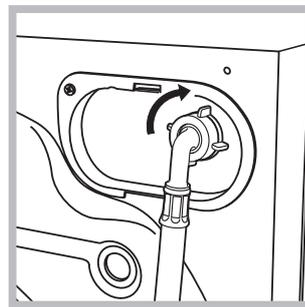
1. Verbind de watertoevoerslang aan de wasautomaat door hem met de haakse aansluiting op de betreffende watertoevoer te schroeven, rechtsboven aan de achterkant (zie afbeelding).
