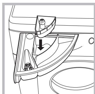
Diese Funktion ermöglicht das Entfernen von hartnäckigen Flecken. Setzen Sie die mitgelieferte, zusätzliche Kammer 3. Bei der Dosierung des Bleichmittels darf der gekennzeichneten Höchststand "max" (**siehe Abbildung**) nicht überschritten werden. Wenn Sie nur bleichen möchten, füllen Sie das
