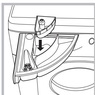
Cette fonction est très utile pour éliminer les taches les plus résistantes. Monter le bac supplémentaire 3 fourni avec l'appareil. Au moment de verser l'eau de Javel, attention à ne pas dépasser le niveau "max" indiqué sur le pivot central (**voir figure**). Pour n'effectuer qu'un blanchissement, verser l'eau de Javel dans le bac supplémentaire 3,
