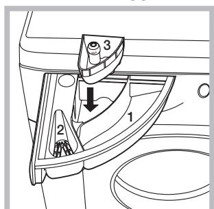
Diese Funktion ermöglicht das Entfernen von hartnäckigen Flecken. Setzen Sie die mitgelieferte, zusätzliche Kammer 3. Bei der Dosierung des Bleichmittels darf der gekennzeichneten Höchststand "max" (siehe Abbildung) nicht überschritten werden. Wenn Sie nur bleichen möchten, füllen Sie das Bleichmittel in die Zusatzkammer 3 ein, stellen
