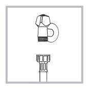
1. Reliez le tuyau d'alimentation en le vissant à un robinet d'eau froide à embout fileté 3/4 gaz (voir figure).
