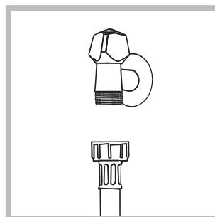
1. Conectar el tubo de tubo enroscándolo a un grifo de agua fría con la boca roscada de 3/4 gas (*ver la figura*). Antes de conectarlo, haga correr el agua hasta que esté limpida.
