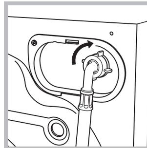
2. Raccorder le tuyau d'arrivée de l'eau au lave-linge en le vissant à la prise d'eau prévue, dans la partie arrière en haut à droite (voir figure).
