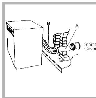
1. Laissez une ouverture dans le mur à gauche l'endroit où sera installé le sèche-linge.
