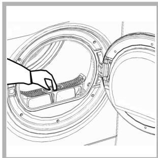
1. Trekk opp plasthåndtaket på filteret (se figur).
