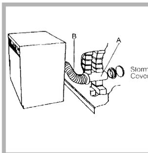
1. La det være en åpning i veggene til venstre for tørketrommelens tenkte plassering.
