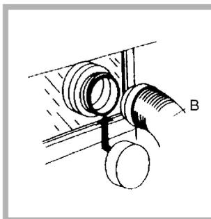
1. Hullet i vinduet bør ideelt sett befinne seg under lufteåpningen.
