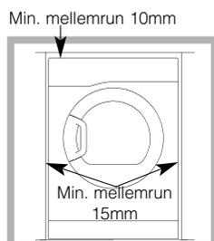
sider og vægge eller møbler. Dette skal sikre tilstrækkelig luftcirkulation. Sørg for, at den bageste luftafgang ikke blokeres.
