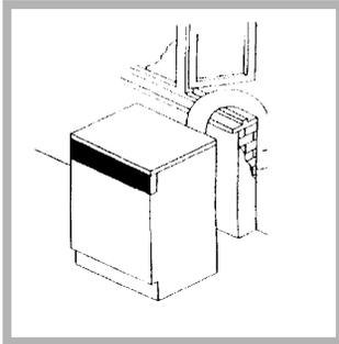
L'extrémité du tuyau doit être dirigée vers le bas, de manière à éviter que de l'air chaud humide se condense dans la pièce ou dans le sèche-linge.
