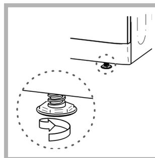
Hvis tumbleren ikke er vandret, anvendes en træklovs som støtte under op- eller nedjustering af de to forreste ben, til tørretumbleren står vandret.
