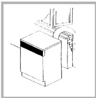
Enden av røret skal rettes nedover for å forhindre at varm, fuktig luft kondenserer i rommet eller i tørketrommelen.
