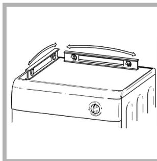
När du har installerat torktumlaren på avsett plats, ska du kontrollera att den ligger plant sidledes och därefter djupledes.
