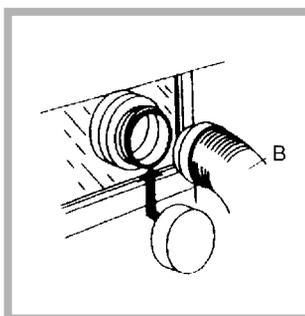
1. Med en højt anbragt tørretumbler skal hullet i vinduet helst være under afgangsen.
