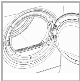
Filteret finnes foran på tørketrommelen (se figur).
