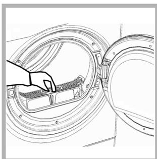
1. Vedä suodattimen muovista kahvaa ylöspäin (**katso kuva**).
