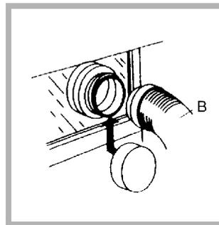
1. Avec un sèche-linge superposé, le trou dans la fenêtre doit idéalement être effectué au-dessous de l'orifice de ventilation.
