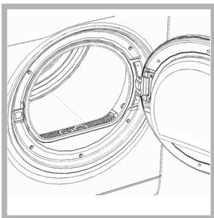
Filteret findes foran på tørren (se diagram).
