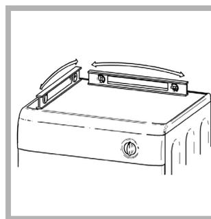
Når du har installert tørketrommelen der den skal stå, kontrollerer du at den står plant, først fra side til side, deretter fra fremsiden til baksiden.
