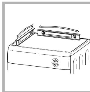
Når tørretumbleren er installeret på sit blivende sted, kontrolleres, at den er vandret, først sidelæns og derefter fremad og bagud.
