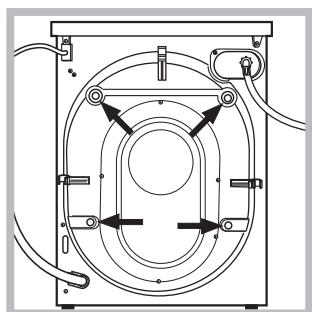
3. Enlever les **4** vis de protection servant au transport, le caoutchouc et la cale, placés dans la partie arrière (*voir figure*).
