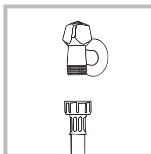
1. Conectar el tubo de tubo enroscándolo a un grifo de agua fría con la boca roscada de 3/4 gas (*ver la figura*).
