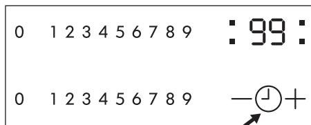
Appuyez sur la touche + ou - du minuteur pour sélectionner un temps compris entre 00 et 99 minutes. Dès que l'indicateur se met à clignoter plus lentement, cela signifie que le compte à rebours a commencé. Réglez le niveau de cuisson.
