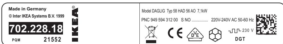
La figure ci-dessus illustre la plaque signalétique de l'appareil (sans le numéro de série, qui est créé dynamiquement pendant le processus de production), située sous le boîtier de la table de cuisson.
