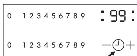
oder des Timers berühren, um die Zeit einzustellen zwischen und Minuten. Wenn die Kontrolllampe nach einigen Sekunden langsamer blinkt, wird die Zeit heruntergezählt. Kochstufen einstellen.
