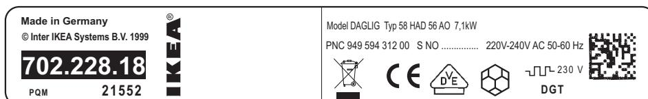
Die Grafik oben stellt das Typenschild des Gerätes dar (ohne die Seriennummer, da diese dynamisch während des Produktionsvorgangs erzeugt wird), das sich an der Gehäuseunterseite befindet.
