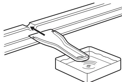
Stellen Sie eine Schale mit warmem Wasser in das Gefrierfach, um den Abtauprozess zu beschleunigen. Entfernen Sie bereits während des Abtauprozesses vorsichtig Eisstücke, die sich lösen lassen.
