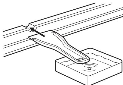
Per accelerare il processo di sbrinamento, collocare un recipiente di acqua calda nel vano congelatore. Rimuovere inoltre i pezzi di ghiaccio che si staccano prima che lo sbrinamento sia completo.
