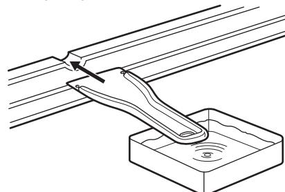
Le dégivrage peut être accéléré en plaçant un récipient d'eau chaude dans le compartiment congélateur. Retirez également les morceaux de glace au fur et à mesure qu'ils se détachent, avant que le processus de dégivrage ne soit terminé.
