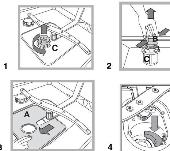
Após a limpeza dos filtros, monte novamente o grupo filtrante e coloque-o correctamente na sua posição; isto é fundamental para o bom funcionamento da máquina de lavar louças.
