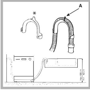
Özel plastik dirsek\*, en iyi düzenin bulunmasını daha kolay bir hale getirir. Çıkış borusunun hareket etmesini ve kirlı suyu dışarı vermesini engellemek için dirseği duvara sağlam bir şekilde sabitleyin. Hortumun A harfi ile işaretlenmiş kısmı, yerden
