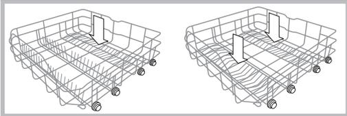
Bazı bulaşık makinesi modellerinde, tabaklar yerleştirilirken dikey pozisyona ve tavalar ve salata kaseleri yerleştirilirken yatay pozisyona getirilebilen eğimli bölümler\* bulunmaktadır.
