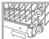
Откройте крепления направляющих корзины справа и слева и выньте корзину. Установите ее сверху или внизу, пропустив ее по направляющим вплоть до входа передних роликов и закройте крепления (см. схему).
