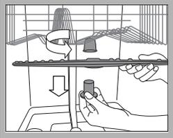
Üst püskürtücü kolu çıkarmak için kilit halkasını saat yönünün tersine döndürün. Üst püskürtücü kol, daha fazla sayıda delik bulunan yüzün yukarıya doğru geldiğinden emin olunması için değiştirilmelidir.
