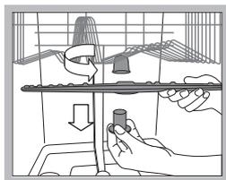
Pour démonter le bras supérieur, il faut dévisser la bague de fixation en plastique (tourner dans le sens inverse des aiguilles d'une montre). Il faut remonter le bras gicleur supérieur, orifices orientés
