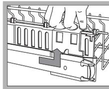
Şayet raf, **Dual Space tutacakları\*** (*bknz şekil*) ile donatılmış ise üst rafı durma noktasına kadar çekin, rafın yanlarındaki tutacakları kavrayın ve isteğe göre yukarıya ya da aşağı doğru hareket ettirin ve yavaşça yerine girmesine yardımcı olun.
