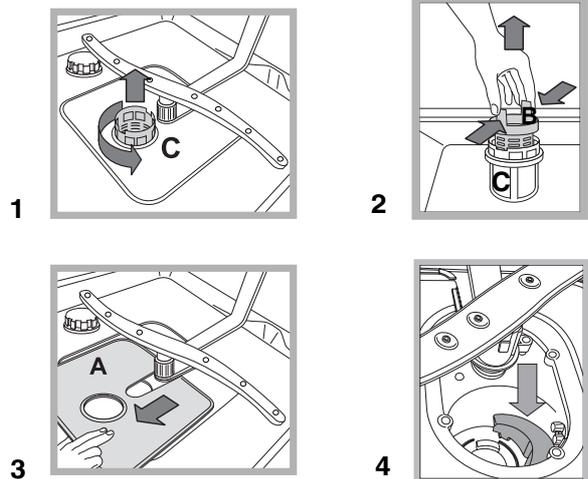
Após a limpeza dos filtros, monte novamente o grupo filtrante e coloque-o correctamente na sua posição; isto é fundamental para o bom funcionamento da máquina de lavar louças.
