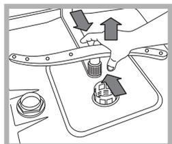
Pour démonter le bras de lavage inférieur, pousser sur les languettes situées sur les côtés et tirer vers le haut.
