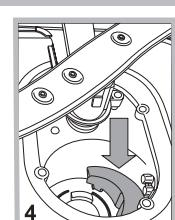
Após a limpeza dos filtros, monte novamente o grupo filtrante e coloque-o correctamente na sua posição; isto é fundamental para o bom funcionamento da máquina de lavar louças.
