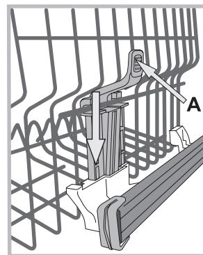
Když je koš vybaven systémem Lift-Up\* (viz obrázek), zvedněte koš po jeho uchopení na bocích a pohněte jím směrem nahoru. Pro návrat do spodní polohy stiskněte páky (A) na bocích koše a doprovodte jej při sestupu směrem dolů.
