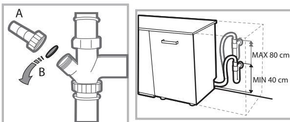
Antes de conectar o tubo de descarregamento da água ao sifão do lavabo, remova a tampa de plástico (B).
