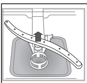
De onderste sproeiarm haalt u uit elkaar door druk uit te oefenen op de lipjes aan de zijkant en door hem daarna naar boven te trekken.
