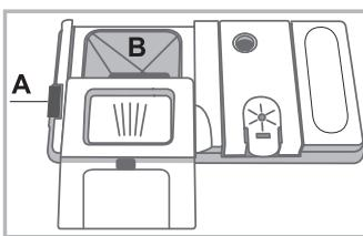
Pro otevření nádobky na mycí prostředek aktivujte otevírací mechanismus „A“.
