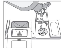
1. Open de houder "D" door het lipje op het deksel in te drukken en omhoog te halen.
