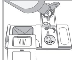
1. Otevřete nádobku „D“ stisknutím a nadzvednutím jazýčku na víku;
