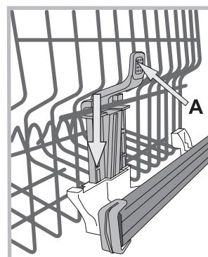
Se o cesto estiver equipado com **Lift-Up\*** (ver figura), levante o cesto segurando-o pelos lados e move para cima. Para regressar à posição baixa, pressione as alavancas (A) nos lados do cesto e acompanhe a descida.
