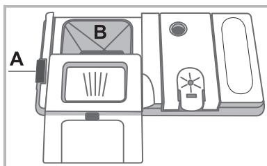
Introduza o detergente apenas no recipiente "B" seco. A quantidade de detergente adequada para a pré-lavagem deve ser colocada directamente na cuba
