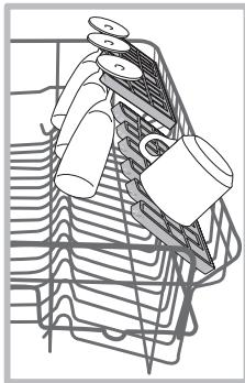
Wijnglazen kunnen op een stabiele wijze op de opklaprekjes worden geplaatst door de voet van het glas in de speciale gaten te steken.
