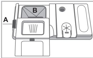
Doe het vaatwasmiddel alleen in het droge bakje "B". Het vaatwasmiddel dat nodig is voor de voorwas moet direct in de vaatwasmachine worden geplaatst.
