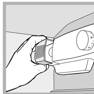
Pak het lampje beet door eerst het beschermingskapje te verwijderen zoals aangegeven in de afbeelding. Vervang het met een lampje dat eenzelfde vermogen heeft als staat aangegeven op het kapje (15 W of 25 W).
