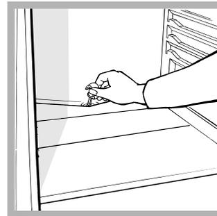
Der Kühlschrank taut automatisch ab: Das Tauwasser wird nach hinten durch eine kleine Ablaufoffnung (*siehe Abbildung*) abgeleitet, wo es dank der vom Kompressor erzeugten Wärme verdunstet. Diese kleine Öffnung sollte jedoch regelmäßig
