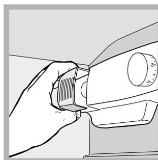
Accedere alla lampada togliendo la protezione come indicato in figura. Sostituirla con una analoga di potenza a quella indicata sulla protezione (10 W o 05 W).
