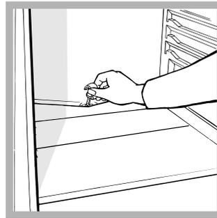
Køleskabet er udstyret med automatisk afrimning. Vandet bortledes i den bageste del gennem aftapningshullet (se figuren), hvor det fordampes af varmen, der produceres af kompressoren. Det eneste vedligeholdelsesindgreb, der skal udføres, består i
