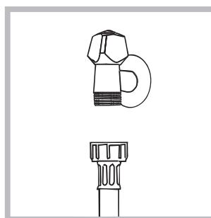
1. Schrauben Sie den Wasserschlauch an einen Kaltwasserhahn mit ¾-GAS-Gewindeanschluss an (siehe Abb.). Lassen Sie das Wasser vor dem Anschluss so lange auslaufen, bis klares Wasser austritt.
