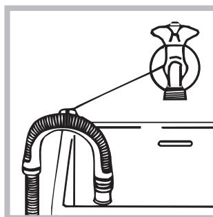
af of hang hem aan de rand van een wasbak of badkuip, en bind de bijgeleverde steun aan de kraan (zie afbeelding). Het uiteinde van de afvoerslang mag niet onder water hangen.
