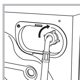
1. Schrauben Sie den Wasserschlauch an einen Kaltwasserhahn mit  $\frac{3}{4}$ -GAS-Gewindeanschluss an (siehe Abb.). Lassen Sie das Wasser vor dem Anschluss so lange auslaufen, bis klares Wasser austritt.
