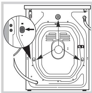
3. Quite los **3** tornillos de protección para el transporte y la arandela de goma con el correspondiente distanciador ubicados en la parte posterior (ver la figura).
