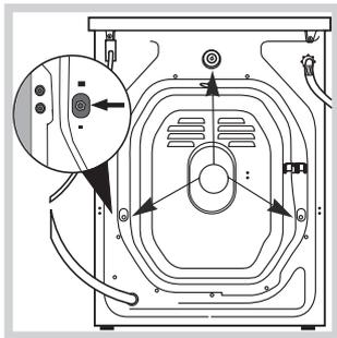
3. Verwijder de 3 schroeven die het apparaat beschermen tijdens het vervoer en de rubberen ring met bijbehorende afstandslider die zich aan de achterkant bevinden (zie afbeelding).
