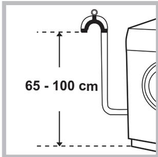
Verbind de buïs, zonder hem te buigen, aan een afvoerleiding of aan een afvoer in de muur tussen de 65 en 100 cm van de grond
