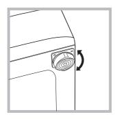
2. Als de vloer niet volledig horizontaal is kunt u de onregelmatigheid opheffen door de stelvoetjes aan de voorkant losser of vaster te schroeven (zie afbeelding); de inclinatiehoek, gemeten
