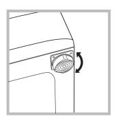
2. Sollte der Boden nicht perfekt eben sein, müssen die Unebenheiten durch An- bzw. Ausdrehen der vorderen Stellfüße ausgeglichen werden (siehe Abbildung), der auf der Arbeitsfläche zu ermittelnde Neigungsgrad darf 2° nicht überschreiten.
