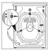
3. Verwijder de 3 schroeven die het apparaat beschermen tijdens het vervoer en de rubberen ring met bijbehorende afstandsleider die zich aan de achterkant bevinden (zie afbeelding).
