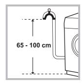
Verbind de buis, zonder hem te buigen, aan een afvoerleiding of aan een afvoer in de muur tussen de 65 en 100 cm van de grond
