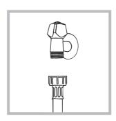
1. Sluit de toevoerbuis aan op de koudwaterkraan met een mondstuk met schroefdraad van 3/4 gas (zie afbeelding). Voordat u de wasautomaat aansluit moet u het water laten lopen totdat het helder is.
