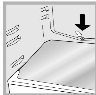
De koelkast is voorzien van een automatische ontdooifunctie: het water wordt door een speciale afvoeropening (*zie afbeelding*) naar de achterkant geleid waar de warmte van de compressor het doet verdampen. Het enige wat u af moet doen is de opening reinigen en controleren of het water vrijuit kan afvloeien.
