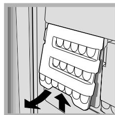
1. Ziehen Sie die Eiswürfelschale nach oben heraus (siehe Abbildung). Vergewissern Sie sich, dass die Schale ganz leer ist und füllen Sie sie durch die entsprechende Öffnung.
