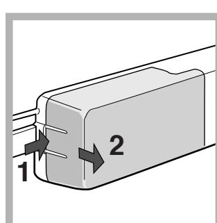
Pak het lampje beet door eerst het beschermingskapje te verwijderen zoals aangegeven in de afbeelding. Vervang het met een lampje dat eenzelfde vermogen heeft als staat aangegeven op het kapje (15 W of 25 W).
