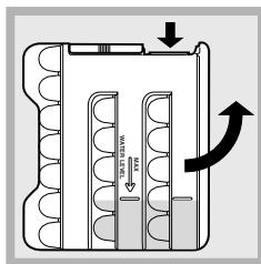
2. Die angezeigte Füllmenge bitte nicht überschreiten (MAX WATER LEVEL). Zu viel Wasser behindert das Herausnehmen der Eiswürfel (in einem solchen Fall warten Sie, bis das Eis schmilzt und entleeren Sie die Schale).
