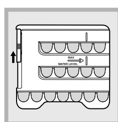
3. Faites pivoter le bac de 90° : l'eau envahit les cavités selon le principe des vases communicants (*voir figure*).
