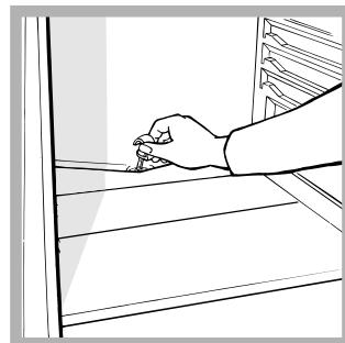
Der Kühlschrank taut automatisch ab: Das Tauwasser wird nach hinten durch eine kleine Ablauföffnung (siehe Abbildung) abgeleitet, wo es dank der vom Kompressor erzeugten Wärme verdampft. Diese kleine Öffnung sollte jedoch regelmäßig gereinigt werden, damit das Tauwasser unbehindert ablaufen kann.
