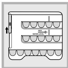
3. Drehen Sie die Schale um 90°: das Wasser läuft in die einzelnen, durch kleine Adern verbundenen Formen (siehe Abbildung)
