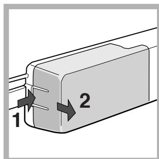
Öffnen Sie die Lampenabdeckung wie auf der Abbildung veranschaulicht. Ersetzen Sie die Lampe durch eine neue derselben Leistung und Bauform (auf der Schutzabdeckung angegeben)(15 W oder 25 W).
