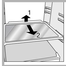
**DRAAGPLATEAU:** plateaus of roosters. Deze kunnen dankzij de speciale gleuven worden verwijderd of in hoogte geregeld (*zie afbeelding*), voor het invoeren van grote verpakkingen of etenswaren. Het is niet noodzakelijk het draagplateau volledig te verwijderen om de hoogte te regelen.
