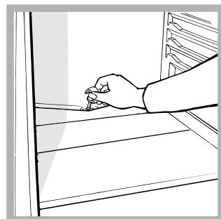
Il frigorifero è dotato di sbrinamento automatico: l'acqua viene convogliata verso la parte posteriore da un apposito foro di scarico (vedi figura) dove il calore prodotto dal compressore la fa evaporare. L'unico intervento da fare periodicamente consiste nel pulire il foro di scarico affinché l'acqua possa defluire liberamente.
