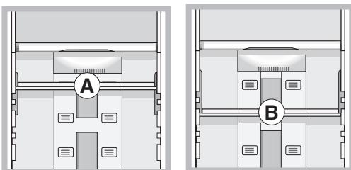
! Fassen Sie die Ablage mit beiden Händen und ziehen Sie sie sanft nach oben bzw. nach unten. Soll die Ablage in Stellung A gebracht werden,.. genügt es, sie anzuheben; sie rastet automatisch ein. Um sie wieder in ihre ursprüngliche Stellung (B) zu bringen, heben Sie die Ablage leicht an und senken Sie sie auf die gewünschte Höhe.
