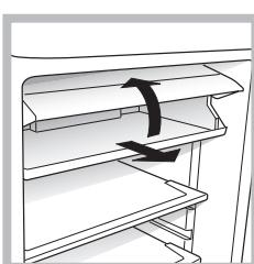
**COOL BOX:** für Frischfleisch und Fisch. Dieses Frischhaltefach ermöglicht lange Aufbewahrungszeiten, bis zu einer Woche, dank der niedrigen Temperatur – die kälteste der Kühlzone. Die Fresh Box kann auch für „Kalte Platten“ eingesetzt werden.
