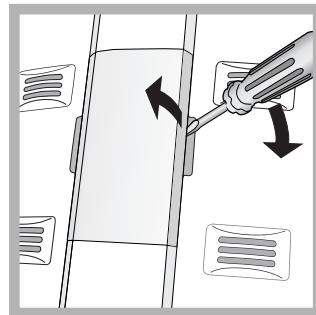
Pour remplacer l'ampoule d'éclairage du compartiment réfrigérateur, débranchez la fiche de la prise de courant. Suivez les instructions fournies ci-après selon le modèle de l'appareil. Pour remplacer l'ampoule, procédez comme illustré (voir figure). Remplacez-la par une ampoule semblable dont la puissance doit correspondre à celle indiquée sur le couvercle de protection (10 W).
