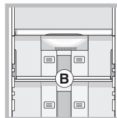
! saisir la clayette des deux mains et d'un mouvement régulier la déplacer vers le haut ou vers le bas. Pour amener la clayette en position A, il suffit de la soulever et elle se bloquera immédiatement, pour la ramener à sa position de départ (B) il suffit de la soulever légèrement et de l'abaisser ensuite jusqu'à la position voulue.
