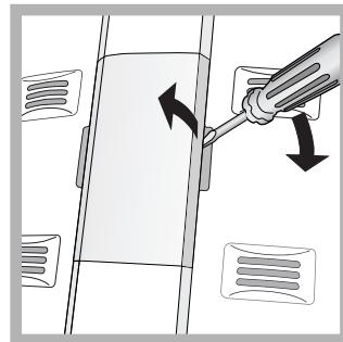
Para sustituir la bombilla de iluminación del compartimento frigorífico, desenchufe el aparato. Siga las instrucciones que se dan a continuación. Acceda a la lámpara quitando la protección como se indica en la figura. Sustitúyala con otra bombilla con una potencia igual a la indicada en la protección (10 W).
