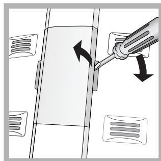
Per sostituire la lampadina di illuminazione del vano frigorifero, staccare la spina dalla presa di corrente. Accedere alla lampada come indicato (*vedi figura*) e sostituirla con una analoga, di potenza non superiore a 10 W.
