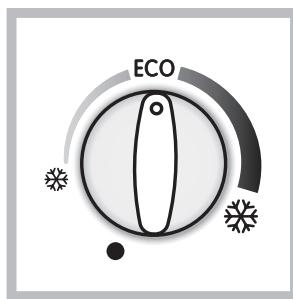
La temperatura all'interno del reparto congelatore si regola automaticamente in base alla posizione della manopola del termostato.
