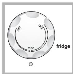
La temperatura interna del compartimento frigorífico se regula automáticamente en base a la posición del mando del termostato.
