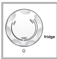
De temperatuur in het koelgedeelte wordt automatisch geregeld aan de hand van de stand van de thermostaatknop.
