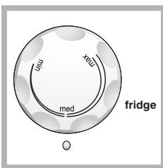
Die Innentemperatur des Kühlzentrums wird automatisch geregelt, je nach Einstellung des Thermostatschalters.
