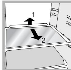
**DRAAGPLATEAU** : deze kunnen dankzij de speciale gleuven worden verwijderd of in hoogte geregeld (zie afbeelding), voor het invoeren van grote verpakkingen of etenswaren. Het is niet noodzakelijk het draagplateau volledig te verwijderen om de hoogte te regelen.
