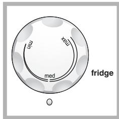
A temperatura no interior do compartimento frigorífico regula-se automaticamente em função da posição do botão para a regulação da temperatura.
