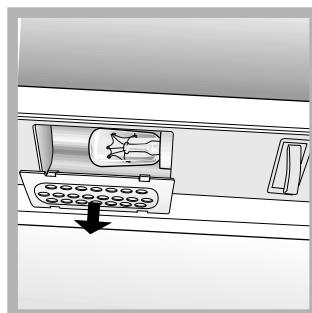
Acceda a la lámpara quitando la protección como se indica en la figura. Sustítúyala con otra bombilla con una potencia igual a la indicada en la protección (10 W).
