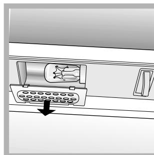
Odmontować zabezpieczenie, aby dojść do żarówki i tak jak wskazano na rysunku. Wymienić na żarówkę o mocy takiej, jaka jest wskazana na zabezpieczeniu (10 W).
