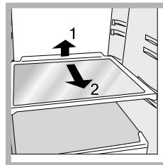
**PÓŁKI:** pełne lub kratki. Można je wyciągnąć, a prowadnice służą do wyregulowania wysokości ich umieszczenia (patrz rysunek) tak, aby umożliwić ustawienie na nich pojemników lub produktów żywnościowych nawet o znaczących wymiarach. Aby wyregulować wysokość nie ma konieczności całkowitego wyjęcia półki.
