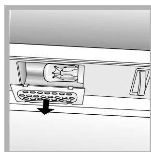
Pak het lampje beet door eerst het beschermingskapje te verwijderen zoals aangegeven in de afbeelding. Vervang het met een lampje dat eenzelfde vermogen heeft als staat aangegeven op het kapje (10 W).
