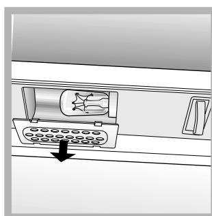
Accedere alla lampada togliendo la protezione come indicato in figura. Sostituirla con una analoga di potenza a quella indicata sulla protezione (10 W).
