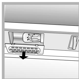
Pour pouvoir remplacer l'ampoule, démontez le couvercle de protection comme illustré (voir figure). Remplacez-la par une ampoule semblable dont la puissance doit correspondre à celle indiquée sur le couvercle de protection (10W).
