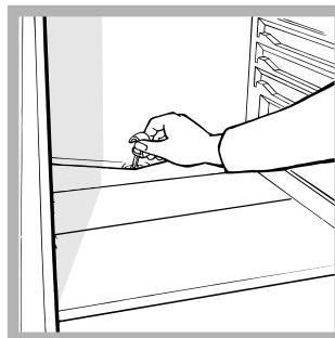
Lodówka jest wyposażona w funkcję automatycznego usuwania oblodzenia: woda odprowadzana jest za lodówkę za pomocą odpowiedniego otworu (patrz rysunek), gdzie ciepło wytworzone przez sprężarkę powoduje jej odparowanie. Jedyną czynnością jaką należy wykonać co jakiś czas, to wyczyszczenie otworu odpływowego tak, aby woda mogła swobodnie wyciekać.
