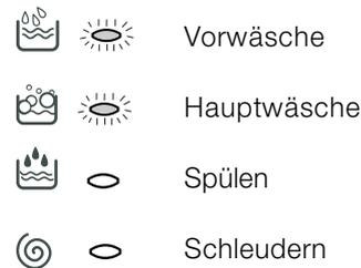
Anmerkung: Während des Abpumpens leuchtet die entsprechende Kontrollleuchte für die Schleuder auf.
