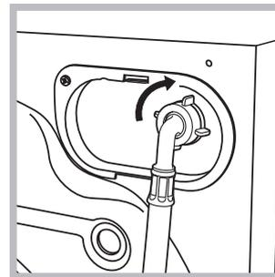
2. Verbind de slang aan de wasmachine door hem op de betreffende watertoevoer aan te schroeven, rechtsboven aan de achterkant (zie afbeelding).
