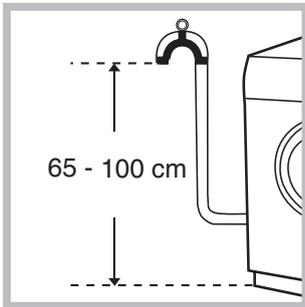
Verbind de buis, zonder hem te buigen, aan een afvoerleiding of aan een afvoer in de muur tussen 65 en 100 cm van de grond af;
