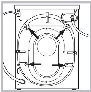
3. Enlevez les 4 vis de protection pour le transport, le caoutchouc et la cale, placés dans la partie arrière (voir figure).
