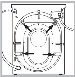
3. Verwijder de 4 transportbouten met de rubberen ring en bijbehorende afstandstukken die zich aan de achterkant bevinden (zie afbeelding).
