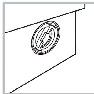
2. draai de deksel eraf, tegen de klok in draaiend (zie afbeelding); het is normaal dat er een beetje water uit komt;
