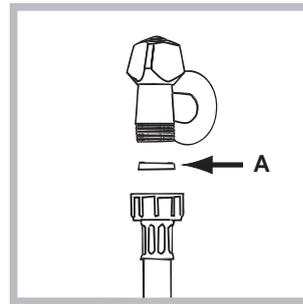
1. Legen Sie die Gummidichtung A in das Anschlussstück des Zulaufschlauches ein und drehen Sie dieses an einen mit Gewindeanschluss von  $\frac{3}{4}$  G versehenen Kaltwasserhahn (siehe Abbildung). Lassen Sie das Wasser
