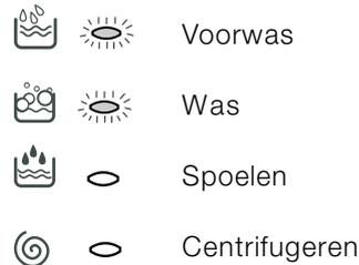
N.B.: gedurende het afpompen gaat het controlelampje dat bij de fase Centrifugeren hoort branden.
