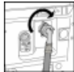
Versorgungsschlauch oben rechts anbringen.
