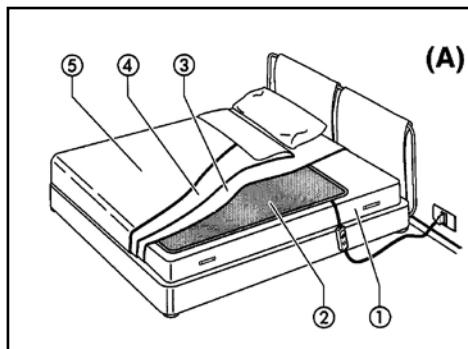
Spreid de elektrische onderdelen (2) gelijkmatig uit over uw matras (1), te beginnen bij het voeteneinde zonder deze onder de kussens te stoppen. De elektrische onderdelen mag niet scherp worden omgevouwen, worden ingestopt of om het matras heen worden gelegd.
