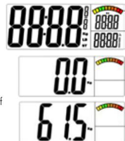
Wenn Sie die Trittfäche verlassen, schaltet sich die Waage nach 15 Sekunden ab. Solange bleibt das Messergebnis sichtbar.
