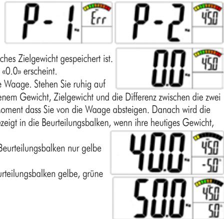
Stellt die Waage bei der Messung einen Fehler fest, wird «Err» angezeigt. Achten Sie darauf, dass Sie die Waage immer zuerst einschalten und die Anzeige «0.0» abwarten, bevor Sie sie betreten.
