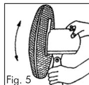
Die Luftaustrittsrichtung kann in senkrechter Richtung wie folgt verändert werden: zur Verstellung des senkrechten Luftaustrittswinkels Motoreinheit «G» nach oben und nach unten bewegen (Fig. 5) und in der gewünschten Stellung hörbar einrasten lassen.
