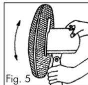
La direction du courant d'air peut être réglée en direction verticale: bouger l'unité du moteur de haut en bas pour modifier l'angle vertical (Fig. 5).
