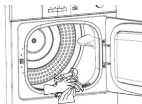
**Le filtre doit être retiré pour nettoyage. (Voir image)**
