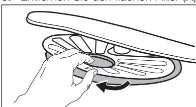
4. Reinigen Sie die Filter.
