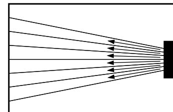
Il sistema a raggiera sviluppato dalla Krüger è predisposto per sfruttare al meglio i vantaggi dell'asciugatura a condensazione e permette di asciugare nel tempo più breve.
