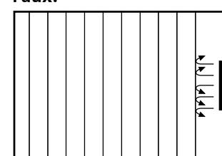
La disposition perpendiculaire des cordes à linge par rapport au sèche-linge empêche le flux d'air de circuler librement ralentissant fortement le processus de séchage du linge suspendu plus en arrière.
