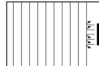
Die quer zum Trockner aufgehängte Wäsche behindert den Luftstrom und bewirkt, dass die weiter hinten aufgehängte Wäsche viel langsamer trocknet.
