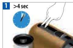
Appuyez et maintenez enfoncé les boutons Espresso & Lungo pendant au moins 4 secondes. L'autre bouton clignote pour confirmation. Press and hold the Espresso & Lungo controls together for at least 4 sec. The other control flashes for confirmation.
