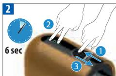
Ouvrez la fenêtre coulissante. Maintenez appuyé les boutons Ristretto et Lungo ensemble pendant au moins 6 sec. L'autre bouton clignote pour confirmation. Puis fermez la fenêtre coulissante pour démarrer l'opération. Open slider. Press and hold the Ristretto & Lungo controls together for at least 6 sec. The other control flashes for confirmation. Then close the slider to start procedure.
