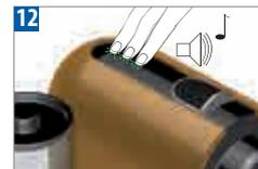
Pour quitter le mode détartrage, appuyez sur les 3 boutons en même temps pendant au moins 3 secondes. La machine émet un bip sonore pour confirmer l'opération. La machine est maintenant prête à l'emploi.
